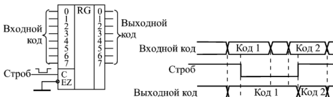
Рис. 8.11. Продление длительности входного кода с помощью регистра-защелки
